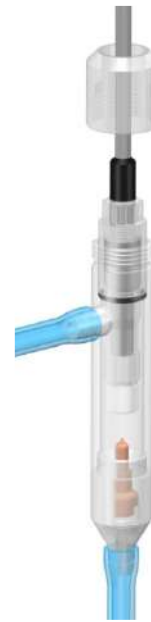
Рис. 3.10. Фиксация АСрО 2 в измерительной камере
